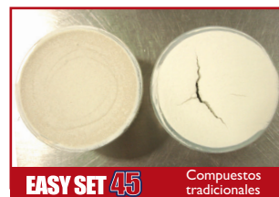
Grado de agrietamiento con espesores altos.
